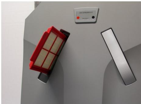
3. Filter aus dem Gerät ziehen.
