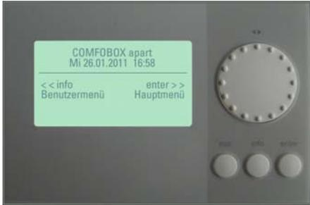
Fig. 7 ComfoBox apart Bediengerät (Heizen, Kühlen, Warmwasser)
