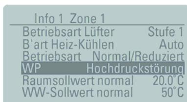
Druck im Kältekreislauf zu hoch (Kondensator):
